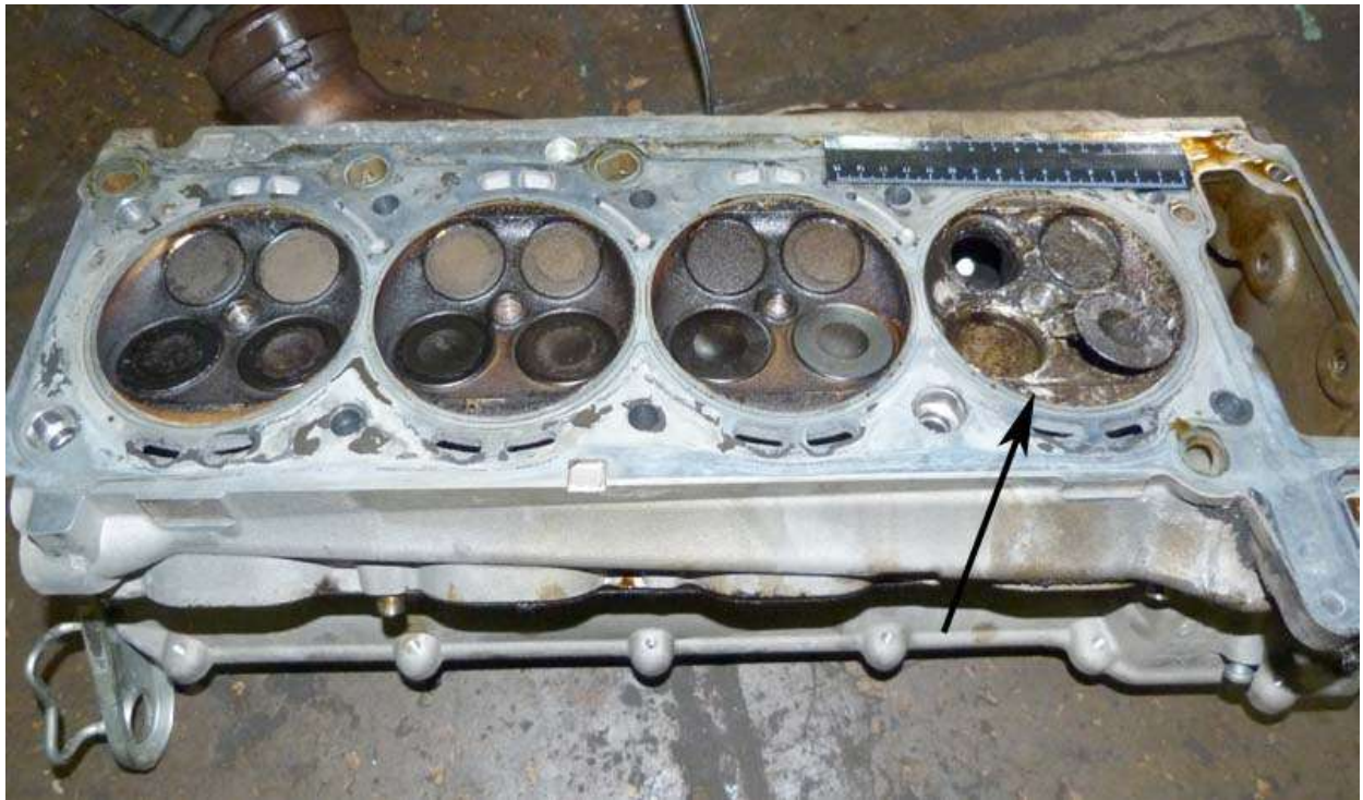
Фото 16. Привалочная плоскость головки блока. Нагар в камерах сгорания — темного цвета. Стрелкой показана поврежденная камера сгорания
