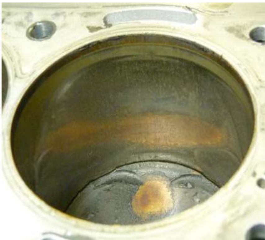
Фото 23. Рабочая поверхность 3-го цилиндра
