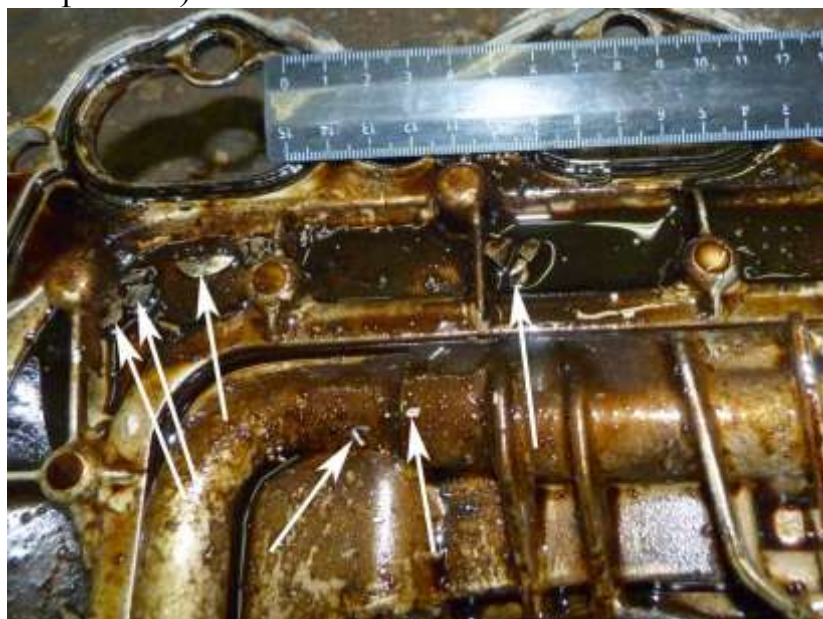
Фото 14. Поверхность впускного коллектора, покрытая моторным маслом (темного цвета). Фрагменты металла показаны стрелками
