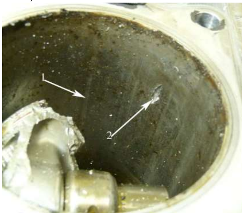
Фото 21. Поверхность цилиндра: 1 — задир; 2 — след удара
