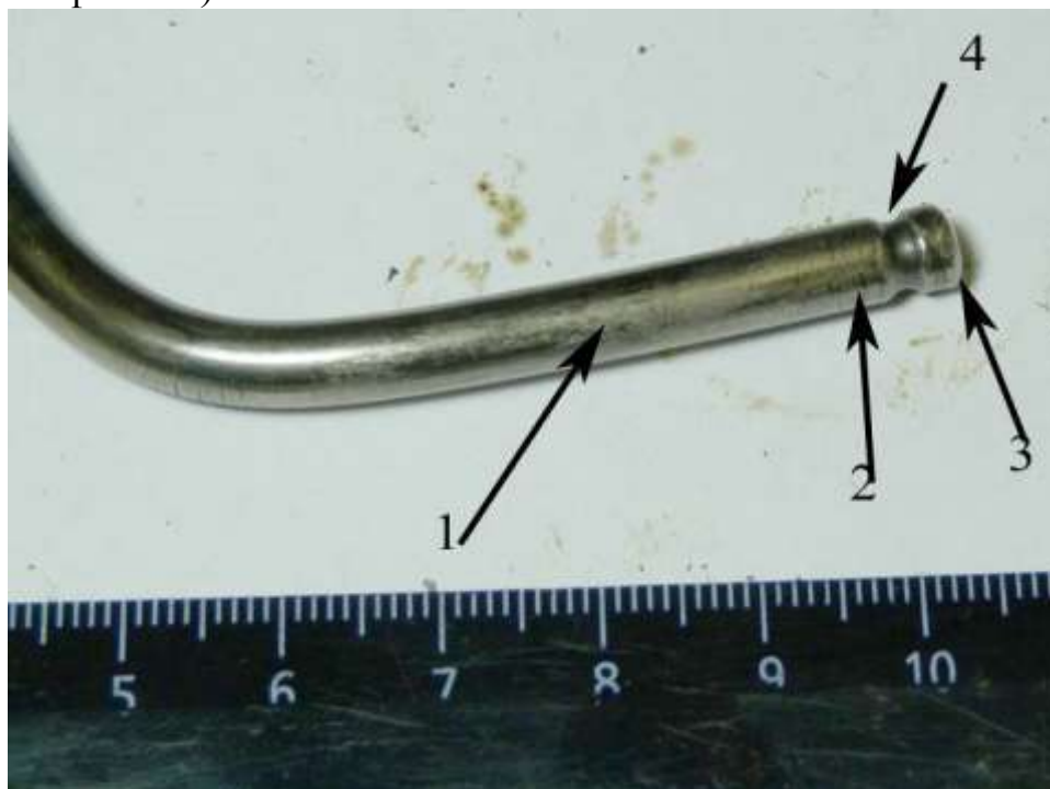
Фото 13. Повреждения стержня клапана: 1 — задиры; 2 — царапины; 3 — следы ударов; 4 — канавка под сухари
