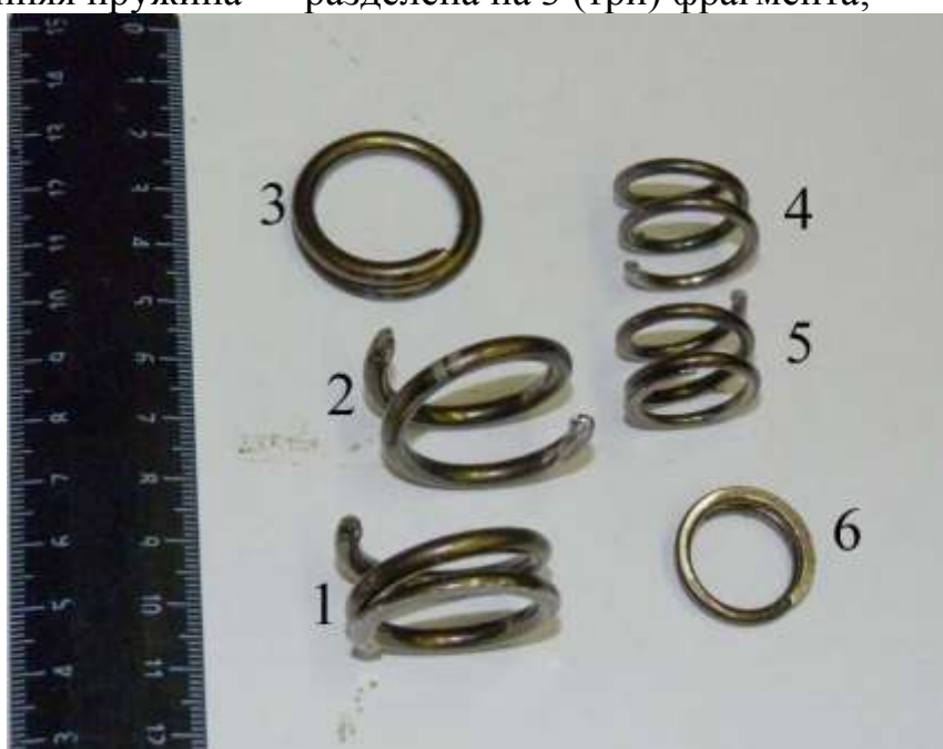
Фото 7. Разрушенные пружины: фрагменты 1-3 — внешняя пружина; фрагменты 4-6 — внутренняя пружина
