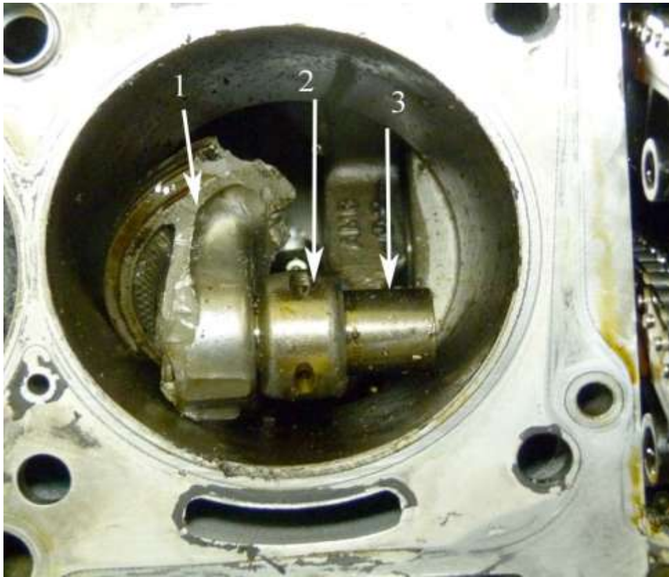
Фото 19. Поврежденный цилиндр: 1 — фрагмент поршня; 2 — верхняя головка шатуна; 3 — поршневой палец
