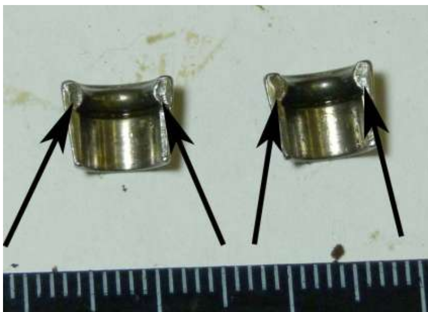
Фото 8. Сухари клапана. Следы ударов показаны стрелками
