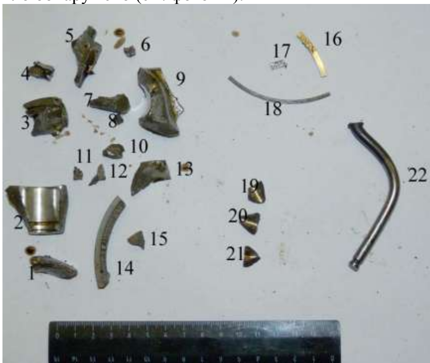
Фото 12. Часть предметов, находившихся во впускном коллекторе: 1-15 — фрагменты поршня; 16-18 — фрагменты поршневых колец; 19-21 — фрагменты направляющей втулки клапана; 22 — деформированный стержень клапана (без тарелки)
