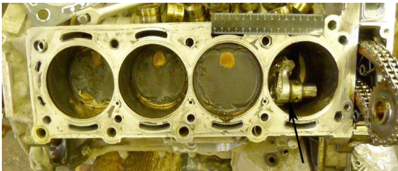
Фото 18. Правый ряд цилиндров с демонтированной головкой блока. Стрелкой показан поврежденный цилиндр
